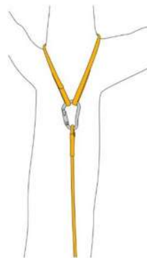
Fig. 5 - Ancoraggio della fune con dispositivo passante
