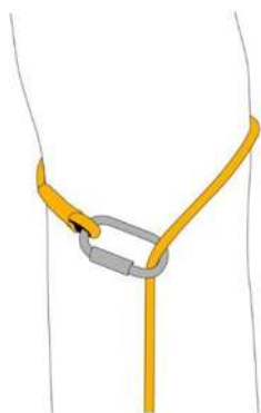
Fig. 2 - Strozzo diretto della fune
